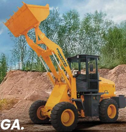
Motor: YN38GBZ1 | Peso operativo: 5230 kg | Capacidad de la cuchara: 0.8 m³ | Carga nominal: 1500 kg | Potencia nominal: 65KW / 87HP
