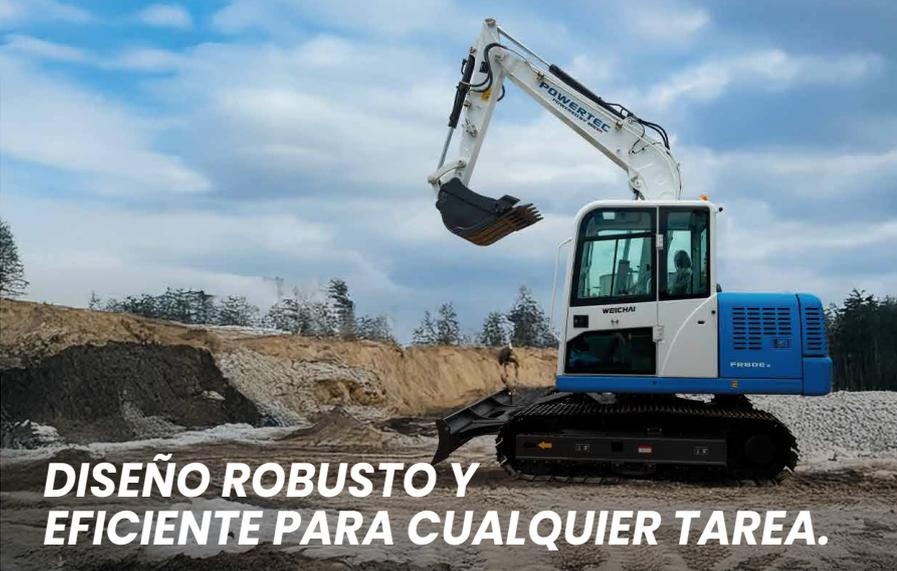
Motor: Yanmar | Peso operativo: 7650 kg | Capacidad de la cuchará: 0.30 m<sup>3</sup> | Potencia nominal: 59.5 HP | Ancho de Zapata: 45 cm
